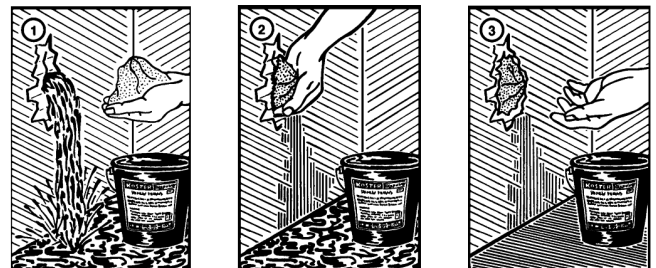
Wassereinbrüche... ..In Sekunden... ..gestoppt!
