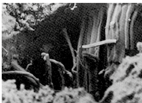
Kristalizacija soli v porah KÖSTER Sanirnega ometa preprečuje nastanek škode zaradi solnega izcvetanja.
