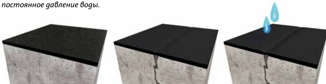
2. Перекрывающая трещины гидроизоляция: в этом случае благодаря эластичности и толщине слоя гидроизоляционное покрытие устойчиво к постоянному давлению воды.
