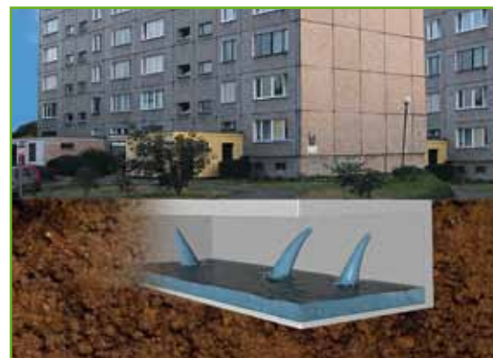
Ofte er der ikke adgang til kældre fra ydersiden. Derfor kan de kun vandtættes fra indersiden (negativsiden).
