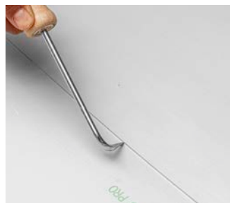
Inspección de costuras con aguja de prueba
