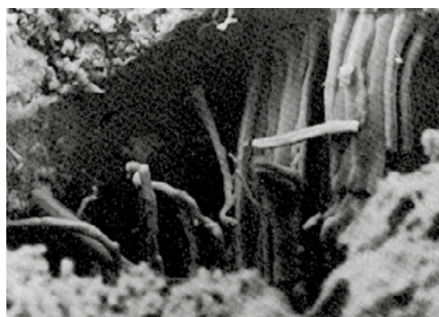
La cristalización de las sales en los poros del KÖSTER Restoration Plaster evita que las sales causen daños.
