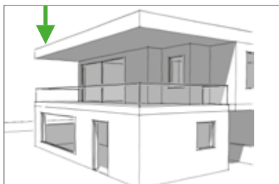
Cubiertas planas de hormigón/azoteas
