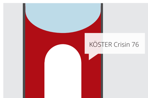
Estrechamiento/bloqueo del capilar, formación de una película elástica en el capilar/reducción del diámetro de los poros.
