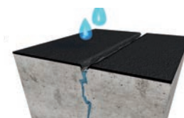
Elástico, pero no puentea las grietas: la capa impermeabilizante no resiste la presión permanente del agua.
