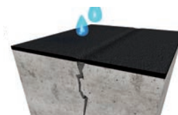
Impermeabilización de puentes de fisuras: En este caso, debido a la elasticidad y al espesor de la capa. La capa impermeabilizante resiste la presión permanente del agua.
