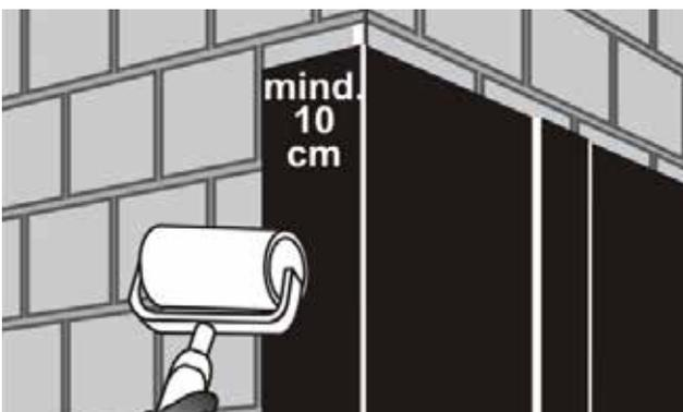
Die Bahn in den Eckbereichen jeweils 10 cm auf die Bauteile kleben.
