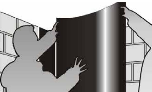
Die KÖSTER KSK-Bahn auf den vorgeklebten Zuschnitt mit mindestens 10 cm Überlappung kleben.
