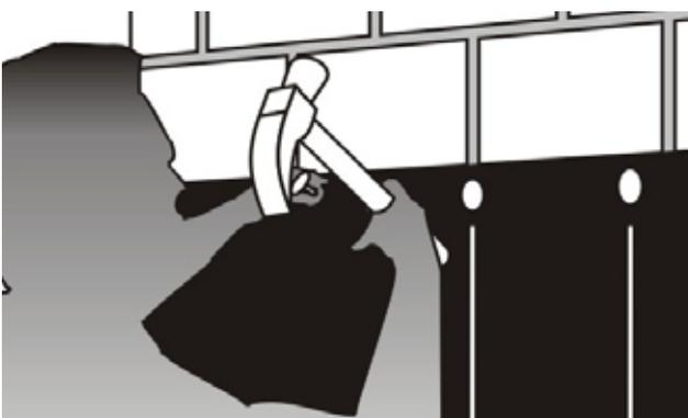
Die obere Bahnsicherung erfolgt mechanisch durch die Befestigung mit Großkopfnägeln.
