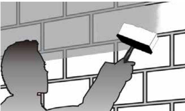
Die Flächen sind mit der KÖSTER KBE-Flüssigfolie, 1:1 mit Wasser verdünnt mit dem KÖSTER Quast für Flüssigkeiten aufzutreiben. Ansatz: 200 g/m<sup>2</sup> KÖSTER KBE Flüssigfolie plus Wasser. Alternativ kann auch der KÖSTER Voranstrich BL mit 150 g/m<sup>2</sup> unverdünnt verwendet werden. Bei saugenden Untergründen muss mit einem höheren Verbrauch gerechnet werden.
