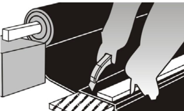
Die KÖSTER KSK-Bahnen mit einem scharfen Messer zuschneiden. Der Zuschnitt sollte auf einem Holzbrett entlang einer Kante als zusätzlicher Unterstützung erfolgen. Die Klinge regelmäßig anfeuchten, um eine Verklebung mit Bitumen zu vermeiden.
