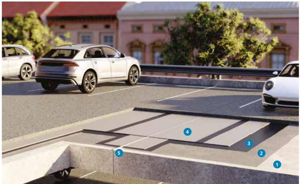
Das KÖSTER Abdichtungssystem für Parkdecks und Brücken besteht aus dem zweikomponentigen Grundierharz KÖSTER CT 225 Brückenharz und den elastischen KÖSTER ECB 2F Abdichtungsbahnen.
