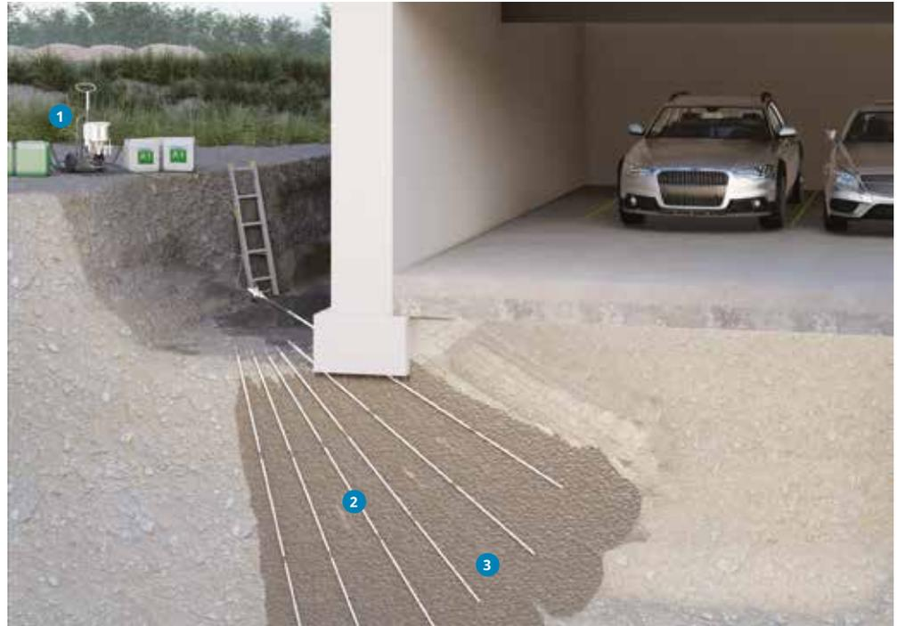
Durch Änderungen des Grundwasserspiegels oder das Vorhandensein von Wasserströmungen innerhalb der Bodenstruktur kann die Feinsubstanz aus dem Untergrund ausgewaschen werden, wodurch Hohlräume im Boden entstehen. Diese Hohlräume können die Integrität der Bodenstruktur verringern, bis sie zusammenbricht. Anzeichen für dieses Phänomen sind meist die Setzungen von Bauwerken oder im schlimmsten Fall die Bildung von Hohlräumen oder Hohlkammern im Boden.
