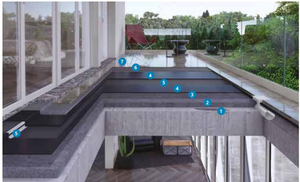
Balkone und Terrassen sind laufend Regen oder Spritzwasser ausgesetzt und unterliegen oft hohen Temperaturschwankungen. Die Abdichtung hat daher in aller Regel rissüberbrückend zu erfolgen.
