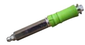
Der Sechskantschraubpacker für Druckverpressungen besitzt einen fest montiertem Kegelkopfnippel und ein Rückschlagventil. Daher kann, unmittelbar nach der Injektion, der aus der Wand herausstehende Teil des Packers abgeschraubt werden. Der zentrale Teil des Packers verbleibt in der Wand und verhindert ein Austreten des Injektionsmaterials und dichtet so das Bohrloch dauerhaft ab. Das Bohrloch kann unmittelbar verschlossen werden.
