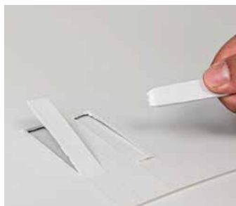
Schältest (2 cm mit Abriss außerhalb der Fügenaht)
