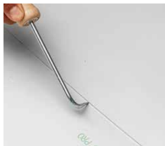
Nahtkontrolle mit Prüfnadel
