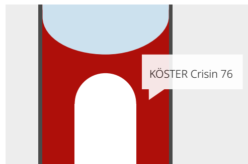
Ožanje/zapiranje kapilare, tvorba elastičnega sloja v kapilari/zmanjšanje premera por.
