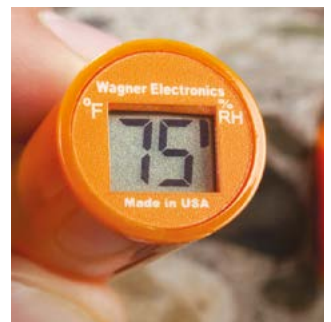
Der RH-Test (relative Betonluftfeuchte)
