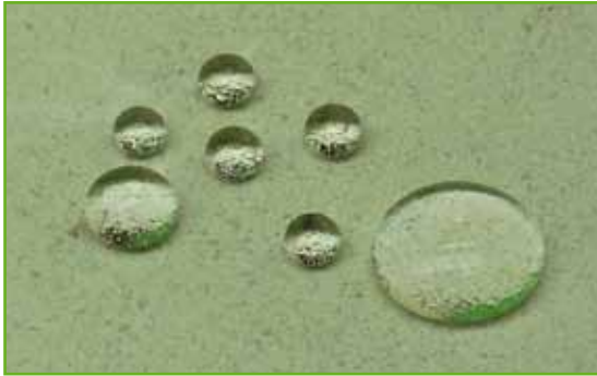
Hydrophobierung: Den Baustoff wasserabweisend machen
